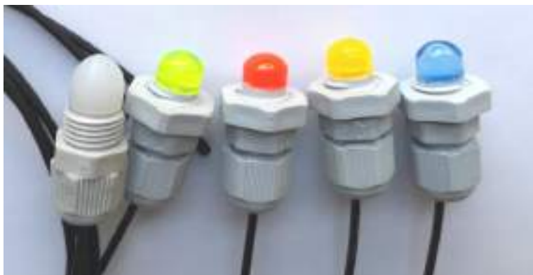
Rys.10. Fotografia czujnika komercyjnego (pierwszy od lewej) oraz czujników wykonanych w ramach pracy
