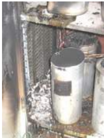
Rys.3. Bateria kondensatorów uszkodzona na skutek przeciążenia prądem podczas rezonansu dla częstotliwości harmonicznej. Efekt błędów projektowych popełnionych przy jej zastosowaniu w sieci zakładu przemysłowego
