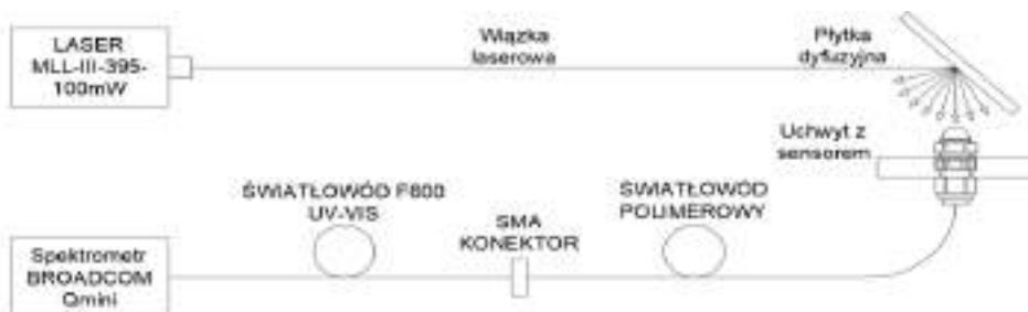
Rys.15. Układ pomiarowy do badania luminescencji materiałów
