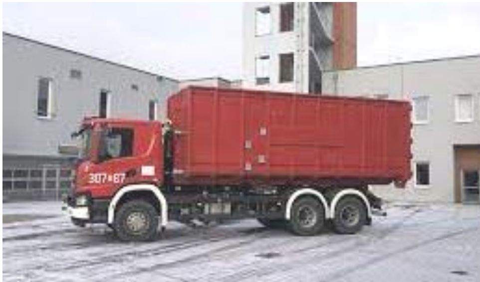
Fot.5. Specjalistyczny wóz z kontenerem do zatapiania płonących pojazdów na wyposażeniu PSP
