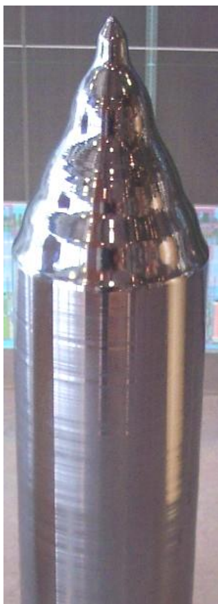
Fot.10. Walec kryształu krzemu otrzymany Metodą Czochralskiego
