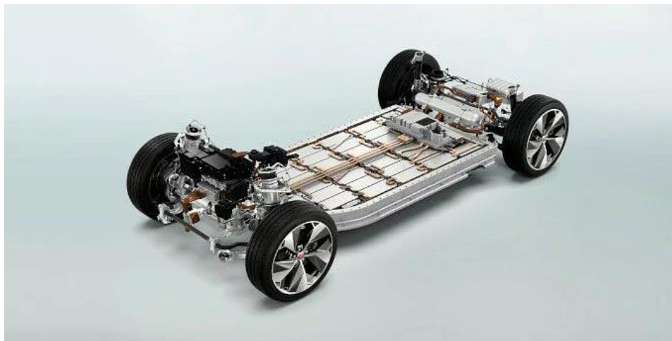
Fot.1. Podwozie elektrycznego pojazdu osobowego z pakietami baterii akumulatorowych
