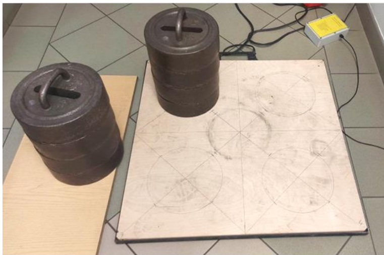
Rys.3. Przykład pomiarów niesymetryczności obciążeniem 100 kg
