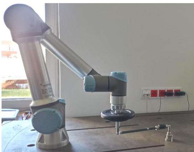
Rys. 6. Stanowisko pomiarowe z użyciem Ballbar
