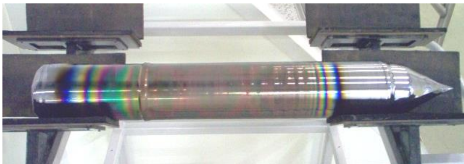
Fot.6, Monokryształ krzemu otrzymany „metodą Czochralskiego”
