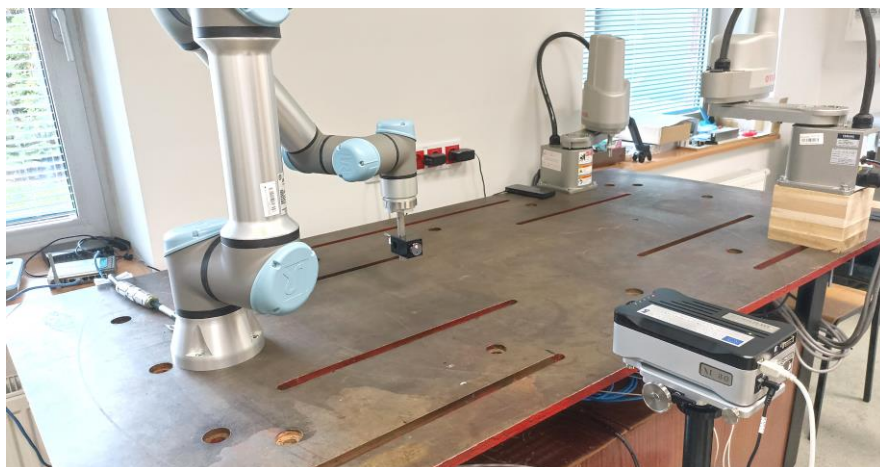
Rys. 8. Stanowisko pomiarowe z użyciem Renishaw XL-80
